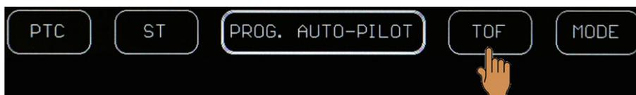
Bouton **TOF**. Lancer directement une mesure de TNM avec le modèle TOF. Pendant que la mesure est en cours, seul ce bouton apparaît avec une couleur différente et la mesure s'arrête en appuyant sur ce dernier.
