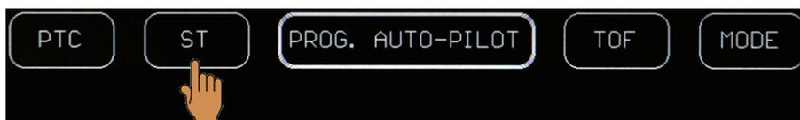
Bouton **ST**. Lancer directement une mesure de TNM avec le modèle ST. Pendant que la mesure est en cours, seul ce bouton apparaît avec une couleur différente et la mesure s'arrête en appuyant sur ce dernier.
