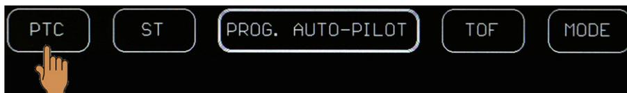
Bouton **PTC**. Par mesure de sécurité, l'on accède à un nouveau menu pour lancer une mesure de la TNM avec le modèle PTC. Pendant que la mesure est en cours, seul ce bouton apparaît avec une couleur différente et la mesure s'arrête en appuyant sur ce dernier.
