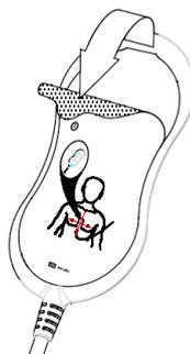
Figure 59 : Préparation de l'autocollant de push-pad : retirez la doublure avant
