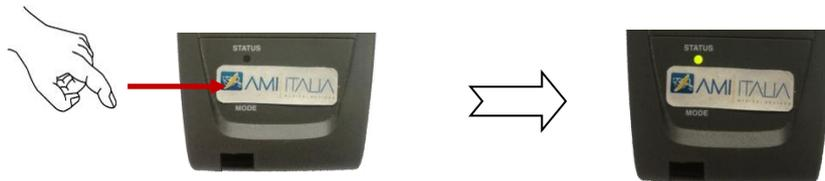
La confirmation de la mise sous tension de l'imprimante se fait par le clignotement asynchrone des trois LEDs et par l'allumage de la première LED avec une lumière verte continue.
